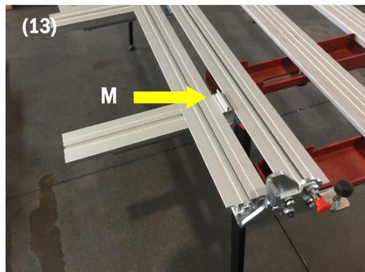
Avvicinare e mantenere accostati i profili (E - G) (fig.14) ai distanziali e serrare i pomelli posti sotto il profilato n° 1 (N) del banco maxi. Mantenendo i profili accostati serrare i pomelli posteriori (N1) dei supporti laterali destro e sinistro.
