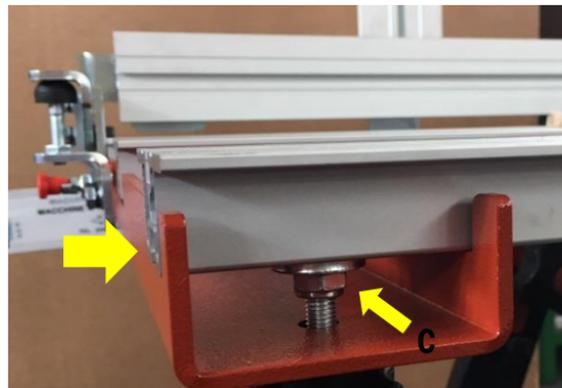
Rimuovere il profilato n° 1 del **Banco** [ ] svitando i pomelli (D) e sostituirlo con il profilato fornito a corredo (E). Avvitare senza serrare i pomelli.
